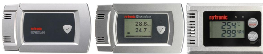
Figure 22 : Enregistreurs de température et d'humidité relative HL20 (gauche), HL20D (centre) et HL1D (droite). PestiRiv, France, 2021-2022.
