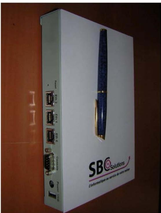
Le boîtier est à faible consommation, 15W. Il ne chauffe pas. Il ne dispose pas de ventilateur et est donc parfaitement silencieux. Il ne crant pas la poussière. Il crant l'eau comme tout équipement électrique.
